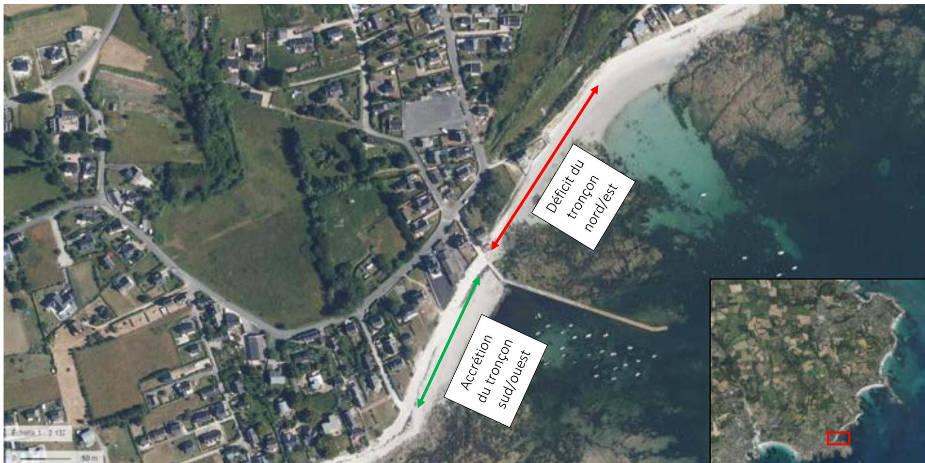
Figure 50 - Impact de la cale de mise à l'eau sur le transit sédimentaire de la plage de Poulluen
