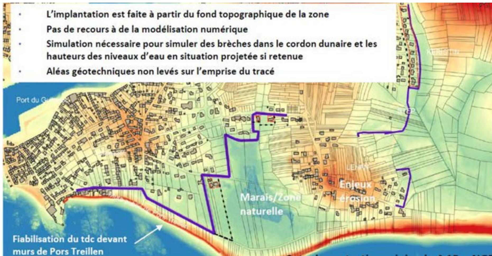
Figure 42 - Protection du bassin de risque submersion de Treffiogat
