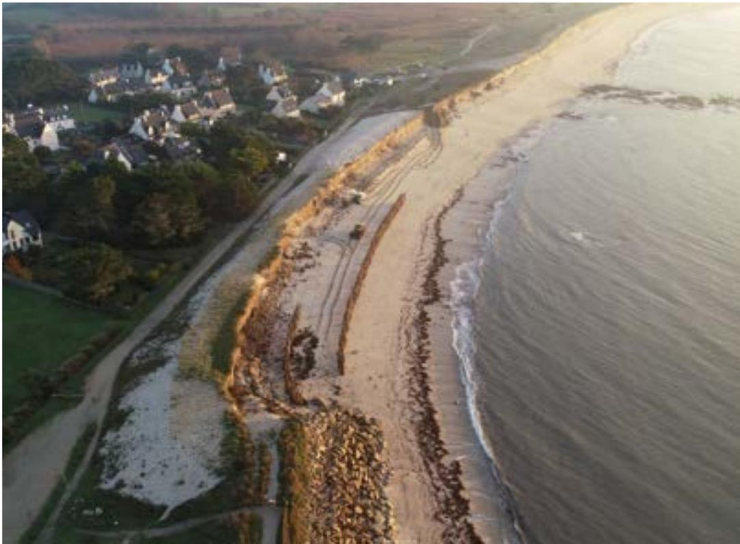
*Figure 32 - Recul du cordon dunaire du Léhan sur la commune de Tréffiagat faisant l'objet d'une opération d'encrochement d'urgence en 2020 (CCPBS, 2020)*
