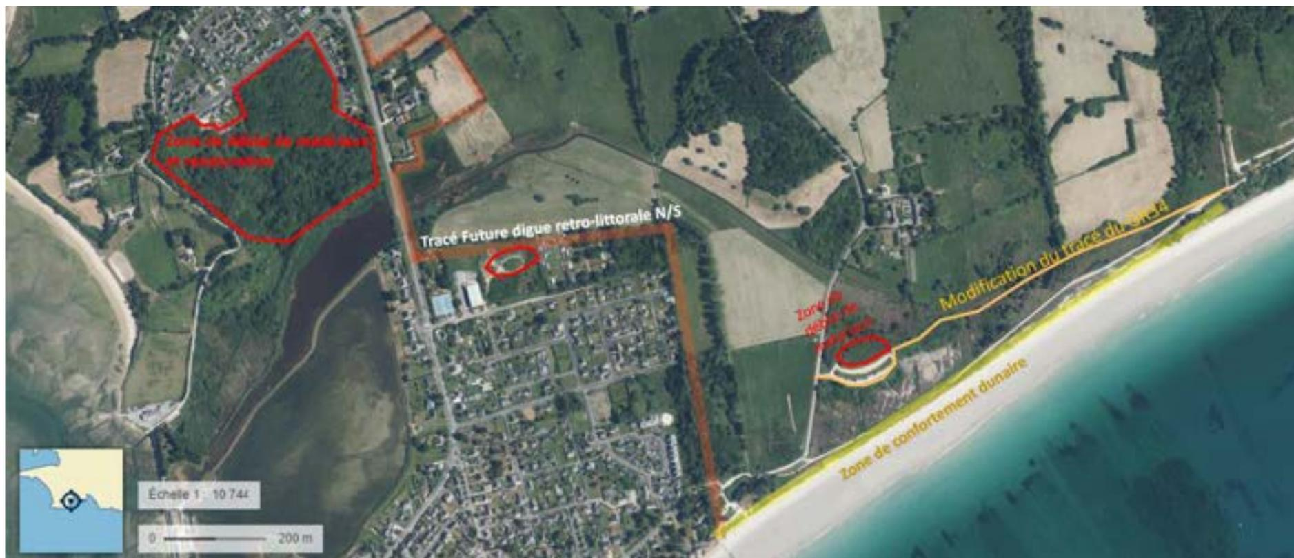
Figure 45 - Projet de protection du polder de Combrit Ile-Tudy
