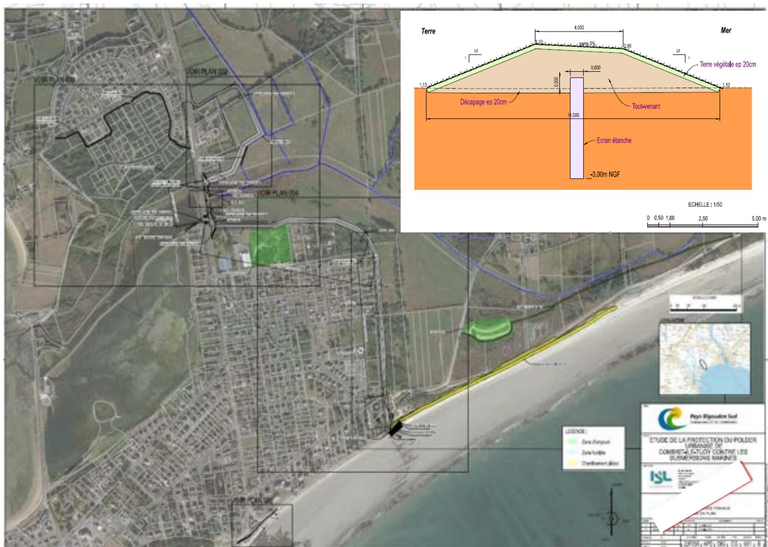
Figures 46 -Projet de protection du polder de Combrit Ile-Tudy et profil type de l'ouvrage retro-littoral
